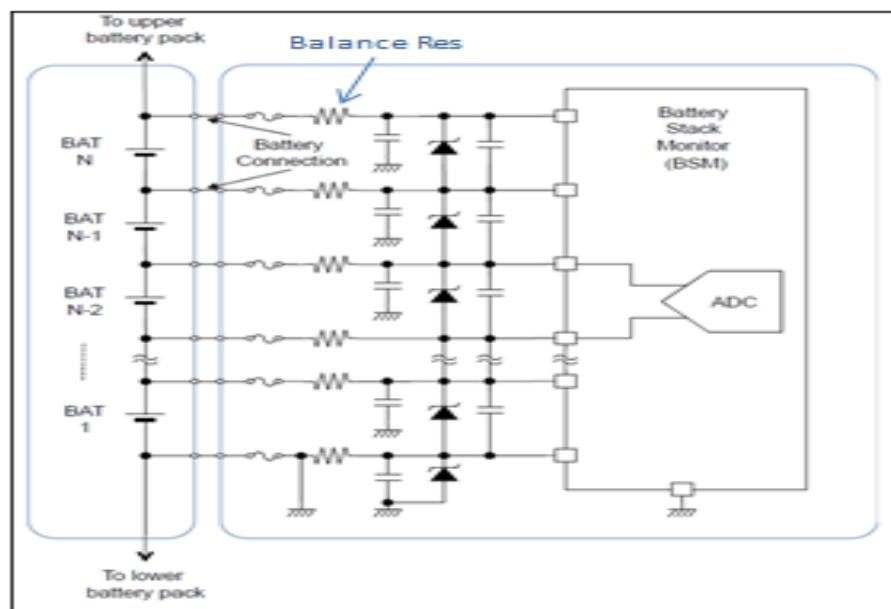
车载电池在使用过程中会出现电池电量不一致，造成电量多的电池无法充分放电；电量少的电池无法充足电量。WR 系列电阻可将多余电量耗散到电阻上来实现电池平衡，从而重新获得将电池充满电并达到完全充电的能力。
