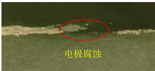
图 1 左端正电极被腐蚀现象图
